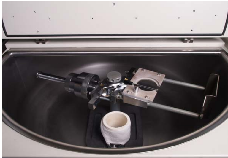
Vano di rifusione con braccio “Doppio Spezzato”(opzionale) e porta crogiolo
